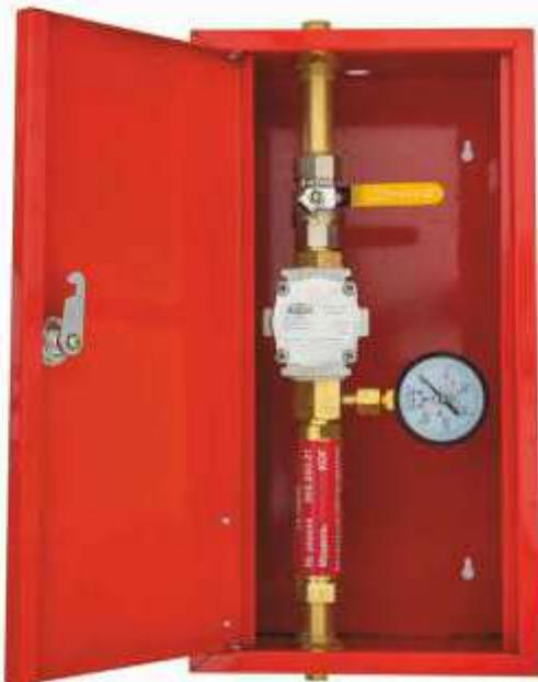
Пост газоразборный горючего газа ПГУ-25-3ДМ устанавливается на газопровод в месте проведения газопламенных работ и предназначен для питания газопламенной аппаратуры горючим газом, контроля давления подаваемого газа, защиты газопроводов от обратных ударов пламени, а также от проникновения в них кислорода и воздуха со стороны потребления.
