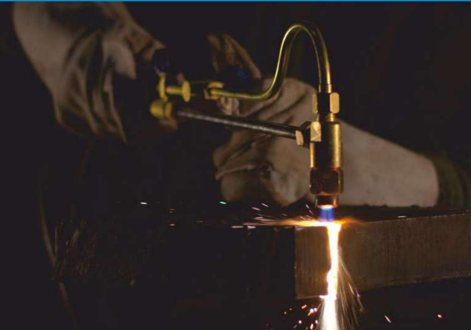
Резаки жидкотопливные типа РК предназначены для ручной разделительной резки низкоуглеродистых сталей толщиной от 3 до 300 мм.
