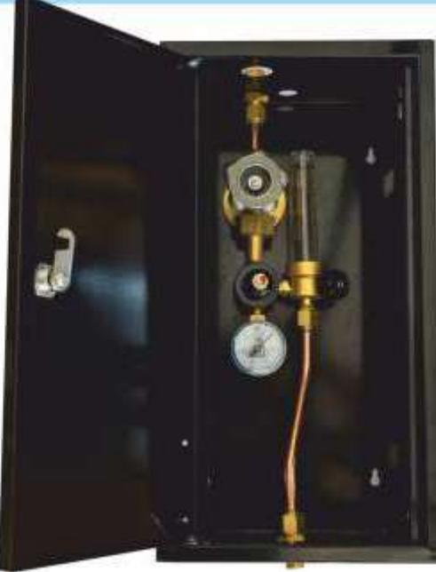
Пост газоразборный Аргон / СО<sub>2</sub> ПГ АР/СО2-25-3 ДМ предназначен для понижения давления, поступающего на пост аргона, углекислого газа или их смеси, и подачи его к месту потребления для питания сварочного оборудования.
