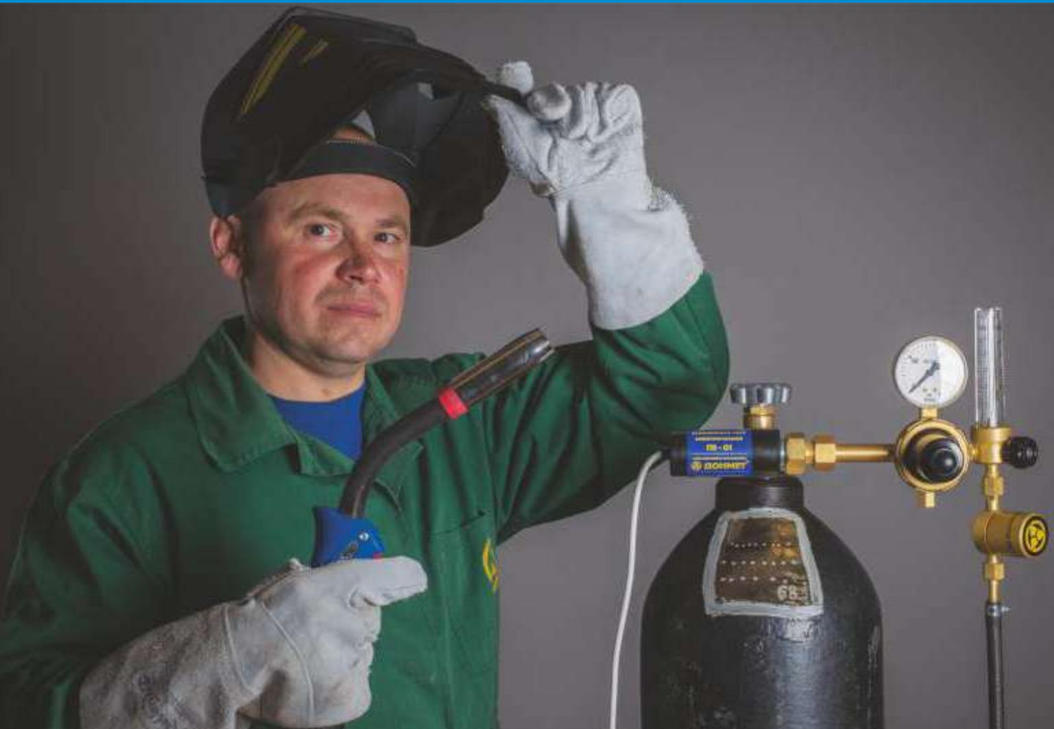
Регуляторы расхода предназначены для понижения давления аргона, углекислого газа или смесей газов, поступающих из баллона, и автоматического поддержания заданного расхода этих газов постоянным при питании электросварочного или другого оборудования.
