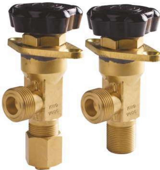
Вентиль запорный продувочный КВО7406 предназначен для установки на системы сжатого воздуха, для воздухоразделительных установок, резервуаров для хранения и транспортирования воздуха на Р ≤ 40 МПа (400 кгс/см<sup>2</sup>). Вентиль является запорным элементом при наполнении, хранении и расходовании через него сжатого воздуха. Допускается использовать в контакте с инертными газами (для Аэродромной наземной спецтехники - универсальные газозарядные станции УЗГС).
