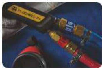
**Предназначен** для предотвращения противотока газа в кислородных и газовых рукавах.
