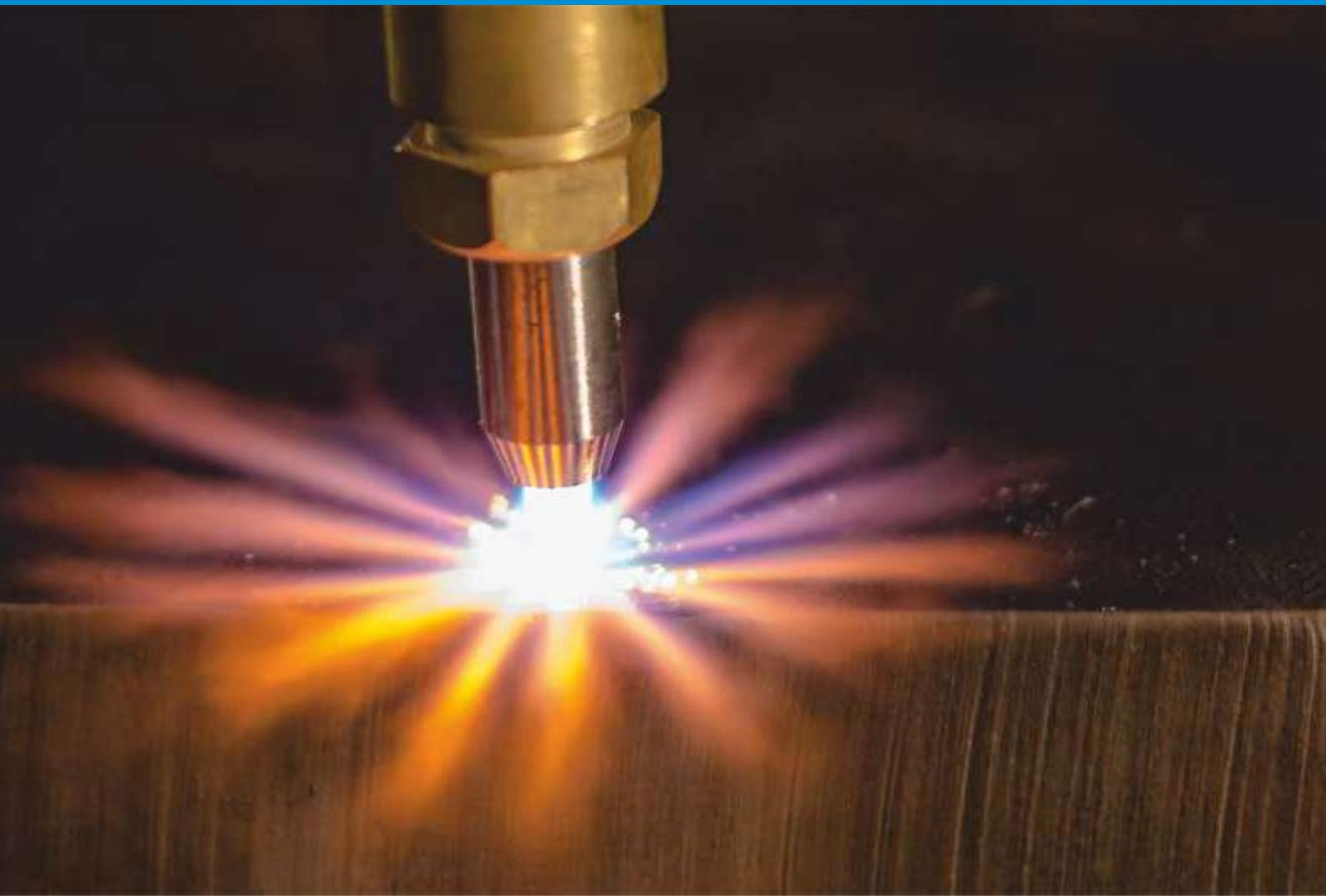
Резаки машинные РМ предназначены для механизированной резки на переносных и стационарных газорезательных машинах.
