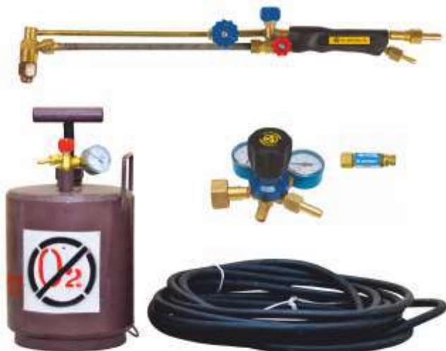
Предназначен для выполнения кислородной резки низкоуглеродистых и низколегированных сталей при наличии источника кислорода (кислородная магистраль, рампа или баллон) и с использованием в качестве горючего жидкого топлива (керосин осветительный, топливо ТС-1, дизельное топливо).
