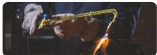
**Толщина реза до** 100 мм
