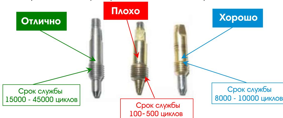
7) Для резаков типа Р3 (для резки металла до 300мм) не допускается применение комбинированных 6/9 ниппелей. Комбинированный ниппель 6/9 уменьшает проходное сечение в 3 раза по сравнению с ниппелем 9, что недостаточно для обеспечения расхода газов.
