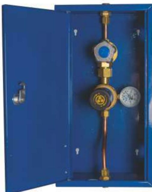
Пост газоразборный кислорода ПГК-10-3ДМ устанавливается на кислородопровод в месте проведения газопламенных работ и предназначен для понижения давления, поступающего на пост кислорода, и подачи его к месту потребления для питания газопламенной аппаратуры кислородом.
