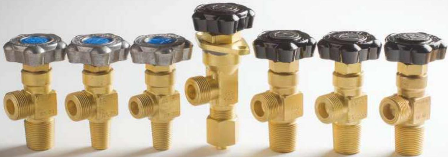
Вентиль является запорным элементом оборудования. Вентили данной серии предназначены для установки на оборудование, работающее под высоким давлением газов и их смесей. Заготовки вентиляй изготовлены путем горячей штамповки, что обеспечивает высокую прочность и качество получаемых корпусных деталей. В качестве смазки подвижных элементов используется кислородо-безопасная смазка LUBCON.
