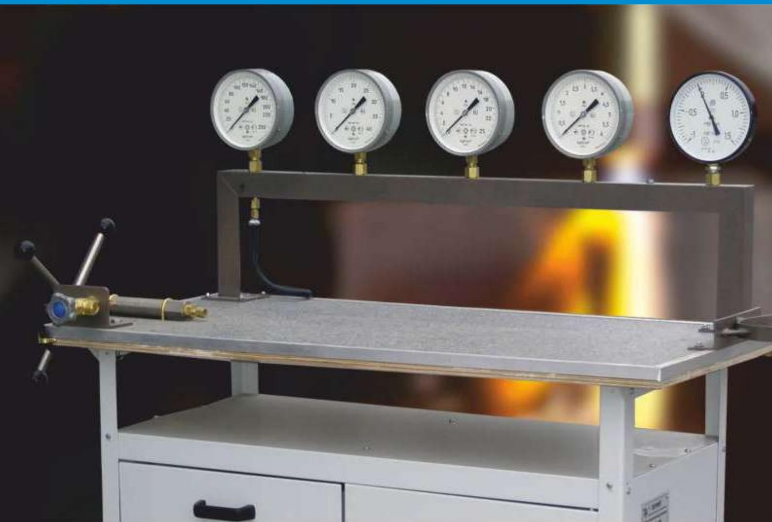
Стенд газовый испытательный предназначен для проверок автогенной аппаратуры и оборудования завода ДОНМЕТ на соответствие требованиям ГОСТ 12.2.008-75, ГОСТ 1077-79, ГОСТ 5191-79, ГОСТ 9356-75, ГОСТ 13861-89, ГОСТ 29091-91, НПАОП 0.00-1.30-01 а также требованиям технических условий, разработанных на основании, указанных стандартов.
