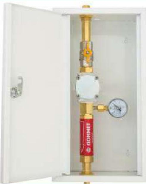
Пост газоразборный горючего газа ПГА-15-3ДМ устанавливается на газопровод в месте проведения газопламенных работ и предназначен для питания газопламенной аппаратуры горючим газом, контроля давления подаваемого газа, защиты газопроводов от обратных ударов пламени, а также от проникновения в них кислорода и воздуха со стороны потребления.
