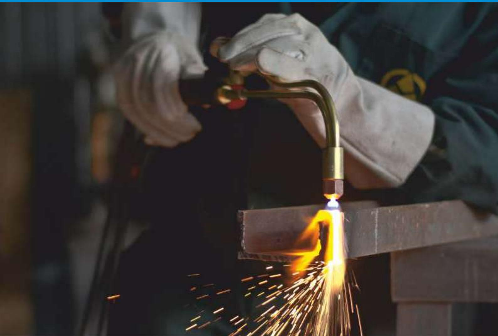
Предназначены для ручной газокислородной разделительной резки низкоуглеродистых сталей толщиной: Р1 - до 100 мм, Р3 - до 300 мм.
