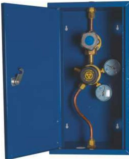
Пост газоразборный кислорода ПГК-50-3ДМ устанавливается на кислородопровод в месте проведения газопламенных работ и предназначен для понижения давления, поступающего на пост кислорода, и подачи его к месту потребления для питания газопламенной аппаратуры кислородом.
