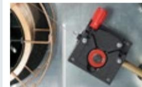
2-х роликовый механизм подачи проволоки
