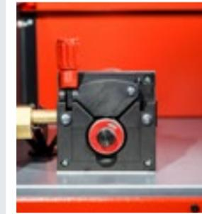
2-х роликовый механизм подачи проволоки
