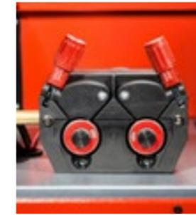
4-х роликовый механизм подачи проволоки
