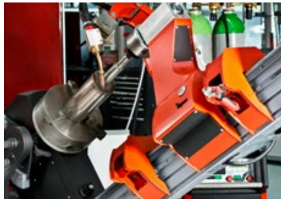
Задняя бабка с синхронным приводом
