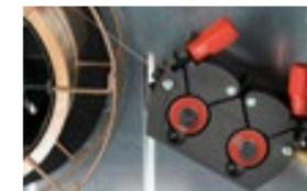
4-х роликовый механизм подачи проволоки
